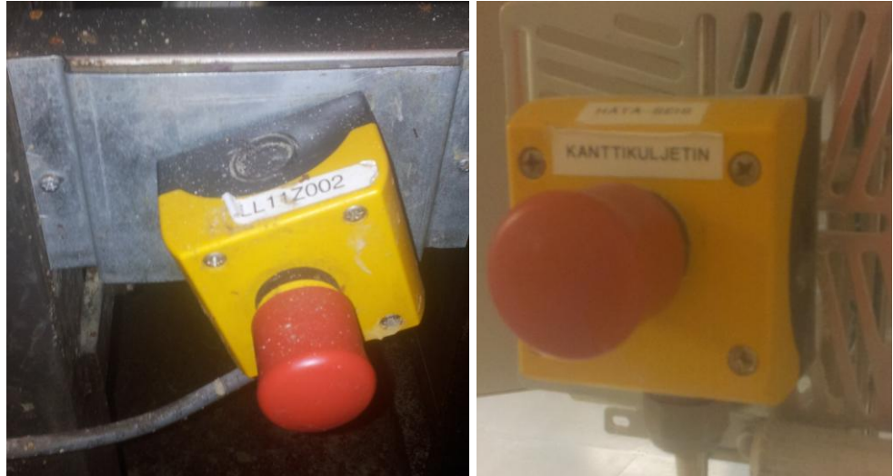
KUVA 10. Hätäseispainikkeen kiinnitysongelma (vas.) ja oikeanlainen hätäseispainike (oik.)
