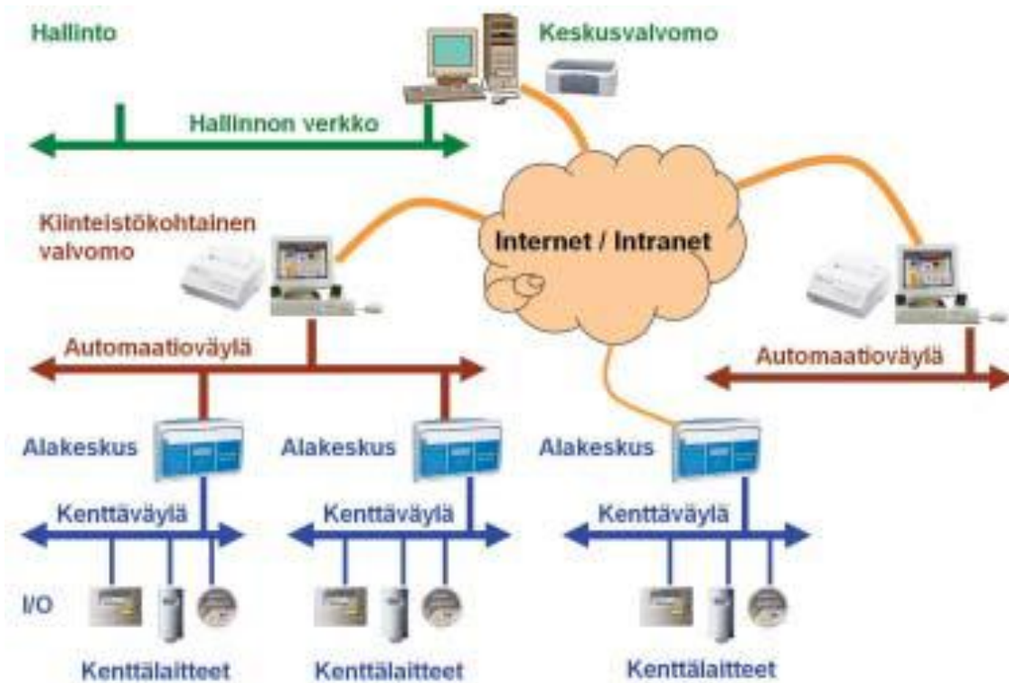
KUVA 2. Hierarkkinen rakenne väyläpohjaisessa järjestelmässä (10, s. 10.)
