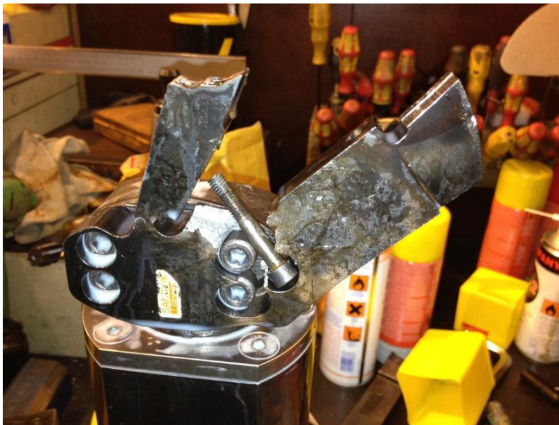
Kuva 1. Resonanssitilanteen seurauksena rikkoontunut sorvaustyökalu (Timo Koutonen 2012)
