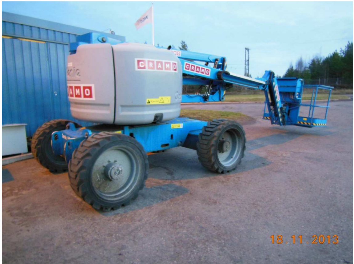
Kuva 2. Henkilönostin joka kulkee omalla moottorilla. (Kuva: Juha Hirvonen)
