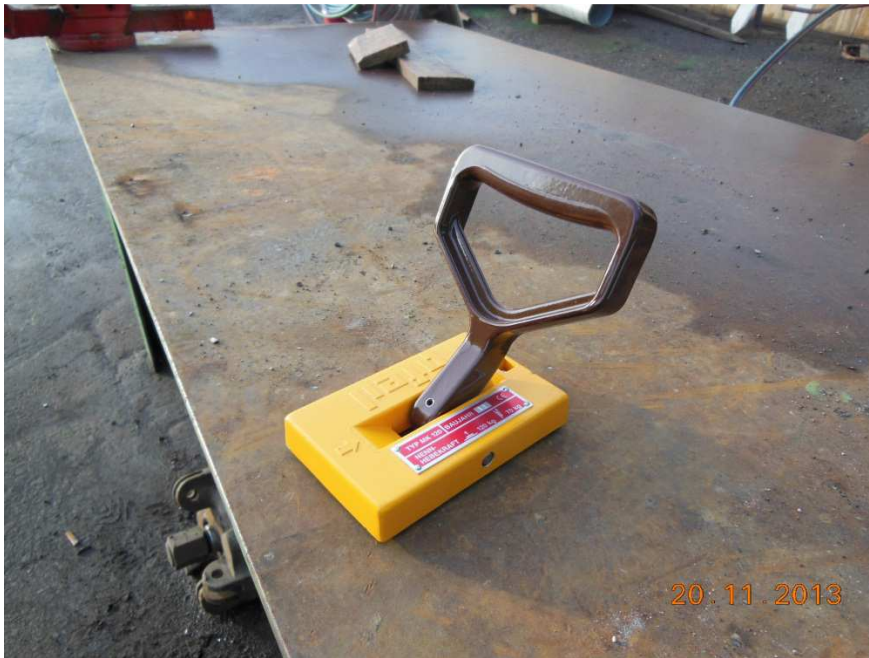
Kuva 3. Magneetilla toimiva rautalevyn nostin. (Kuva: Juha Hirvonen)
