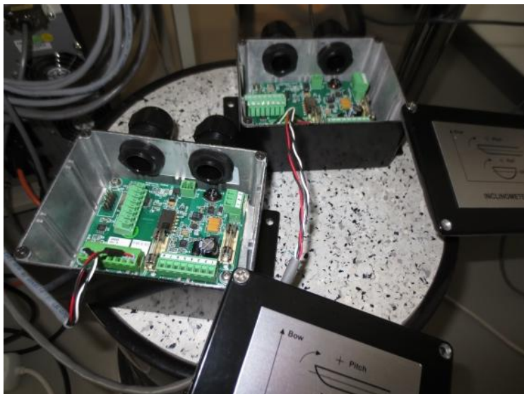
Kuva 20. Kaksi VRS-laitetta kytkettynä testattavaan järjestelmään. Yksinkertaisen kytkennän vuoksi testattava VRS on nopea kytkeä ja irrottaa.
