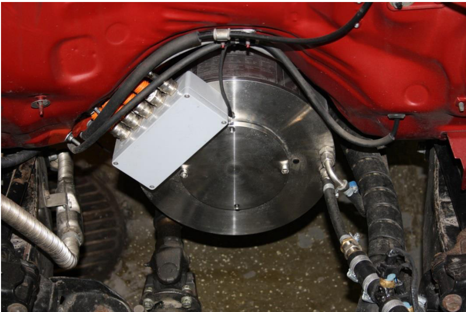
Kuva 11. Sähkömoottori kiinnitettynä alkuperäiseen alennusvaihteeseen
