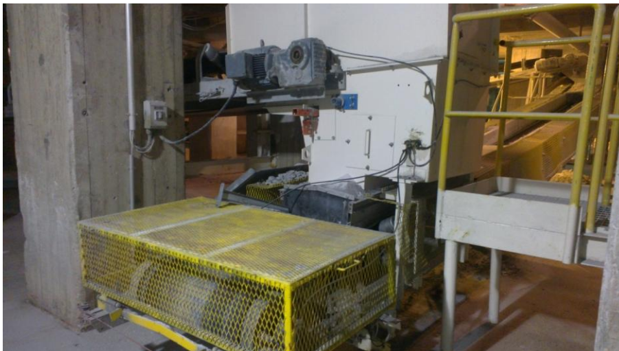
Kuva 3. Hihnakuljettimen koneikko (Kuva: Aapo Räsänen).
