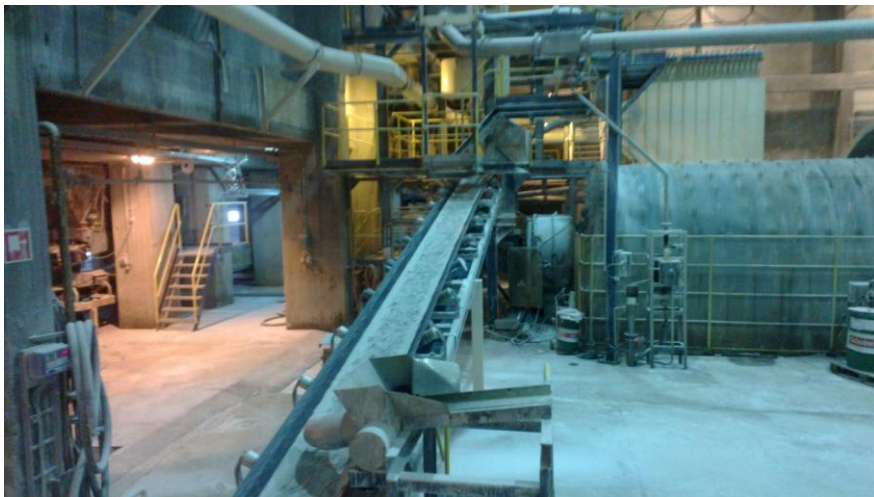
Kuva 5. Iskupalkkimurskaimelta kuulamylylle kuljettava hihnakuuljetin (Kuva: Aapo Räsänen).
