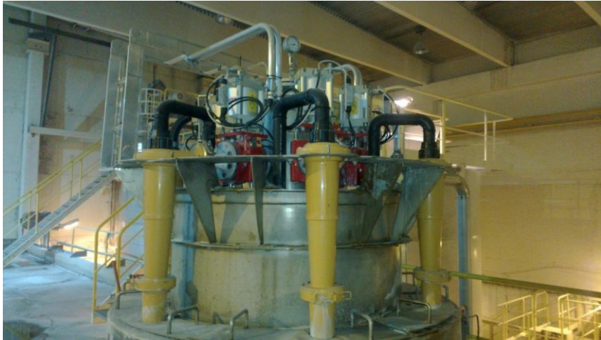
Kuva 7. Nikkelsykloni (Kuva: Aapo Räsänen).
