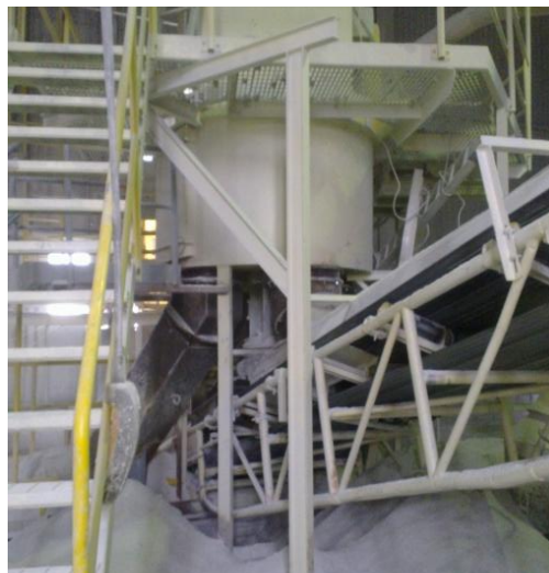
Kuva 1. Pyörivä jakolaatikko (Kuva: Aapo Räsänen).
