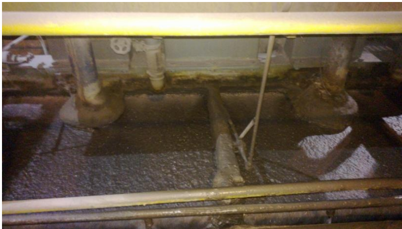
Kuva 9. Vaahdotuskenno. Vaahtomainen harmaa rikaste näkyvissä (Kuva: Aapo Räsänen).
