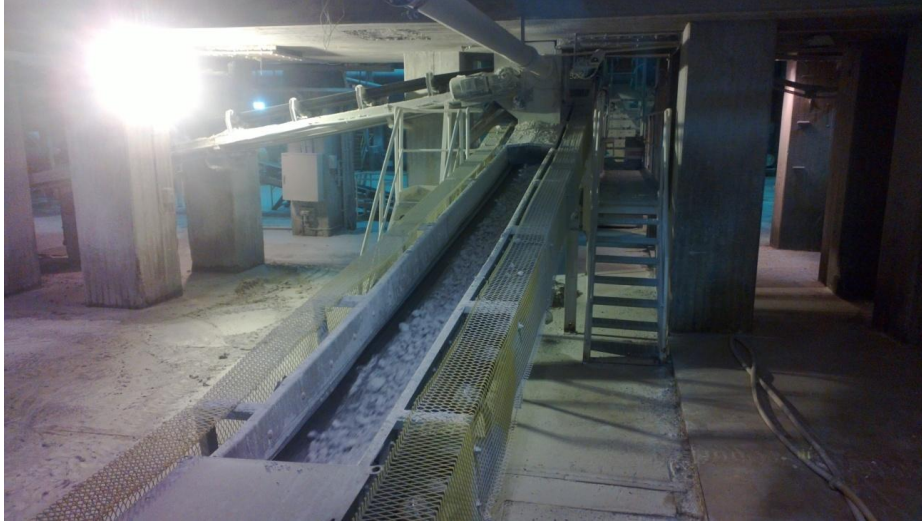
Kuva 2. Iskupalokkimurskaimelle kulkeva hihnakuljetin (Kuva: Aapo Räsänen).
