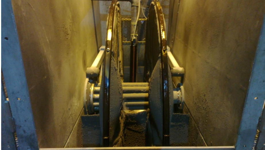
Kuva 11. Nikkeli-kiekkosuotimen kiertävät pussit toiminnassa (Kuva: Aapo Räsänen).
