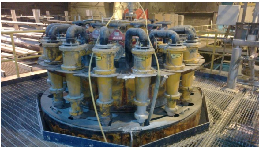
Kuva 8. Talkkisykloni (Kuva: Aapo Räsänen).
