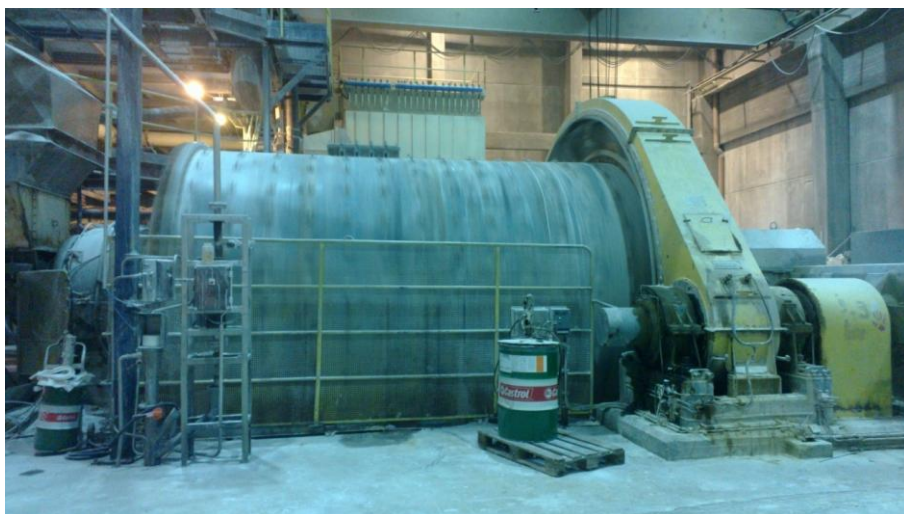
Kuva 6. Kuulamyly toiminnassa (Kuva: Aapo Räsänen).
