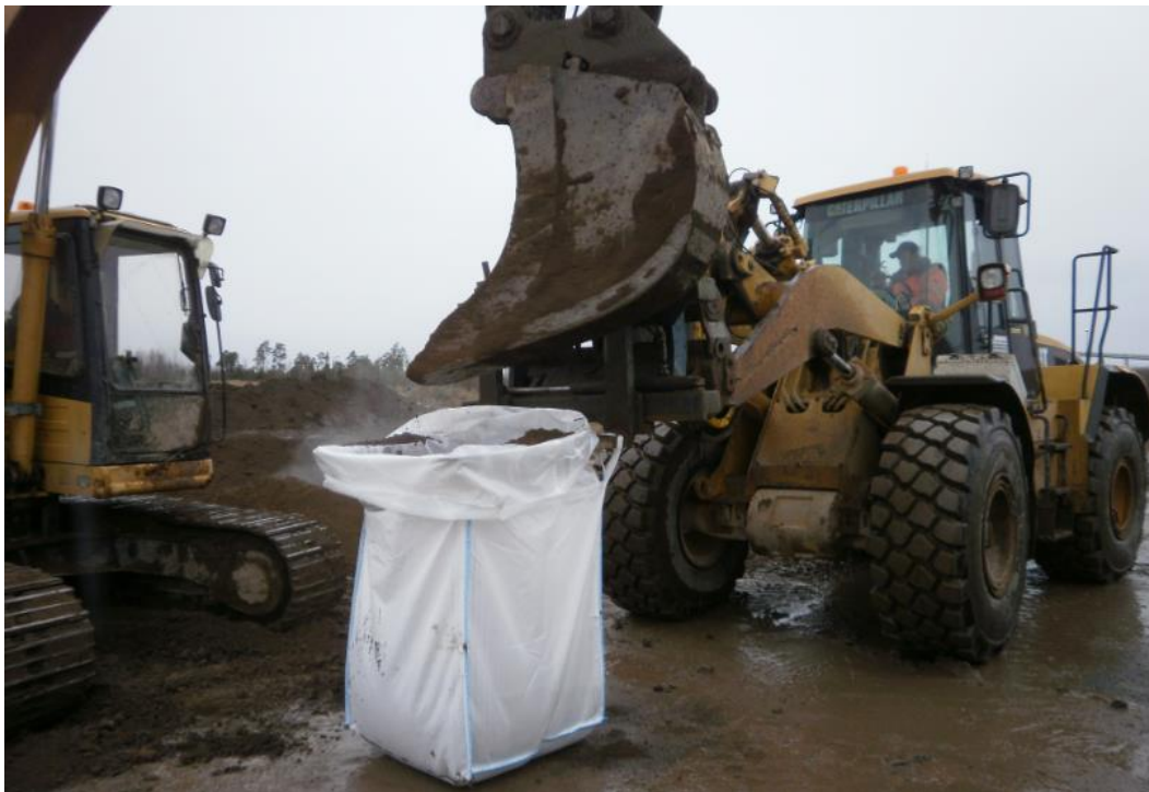
Kuvio 2. Kaivinkone täyttää trukkipiikeillä olevaa säkkiä.
