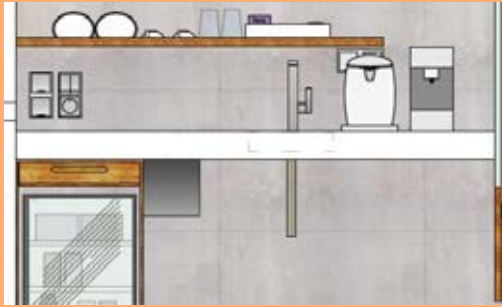
KUVA 93. Hyllyt ja sähköpistoruokkeet sopivalla käyttökorkuudella (Nenonen 2013)
