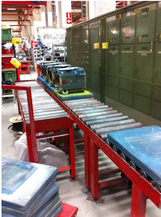
Kuvio 14. AL 15- runkoonpuristuksen ja liitännän välinen rullarata.
