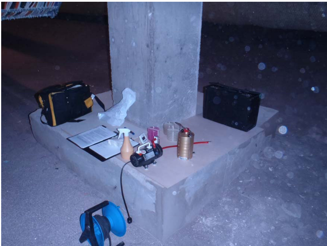
Kuva 8. Kohteen A ryömintätilassa Andersen-mittaus tehtiin anturan päällä.
