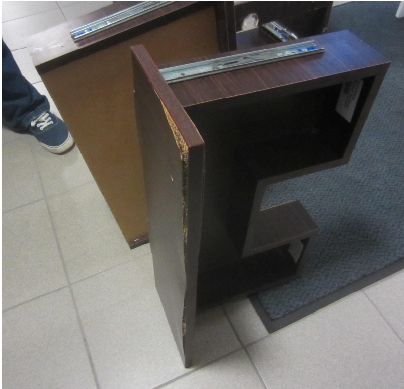
Kuva 4. Kalusteen etulevy ei kestä kosteusrasitusta [6.]
