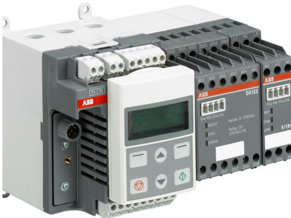
Kuva 5. UMC100-FBP laajennettuna UMC100-PAN-, DX112- ja VI150-laajennusmoduuleilla. [2.]
