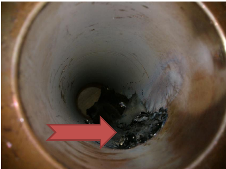
Kuva 21 Sulannut kokillin sisäpinta
