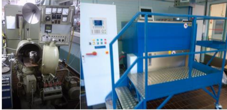
Kuva 10 Balzers induktiouuni vasemmalla, uusi Linn-uuni oikealla
