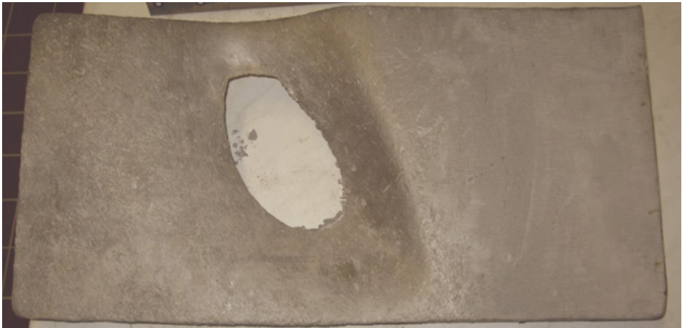
Kuva 19. Käytöstä poistettu EN 1.4301-levy /40/
