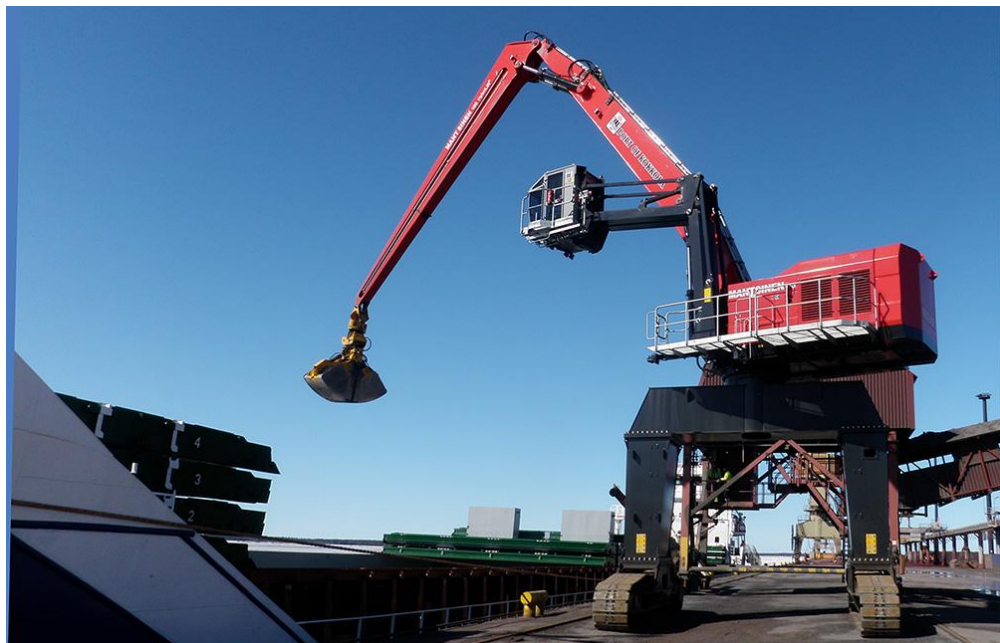
Kuva 3. Mantsinen 120 R -materiaalinkäsittelykone (Mantsinen Group 2014).
