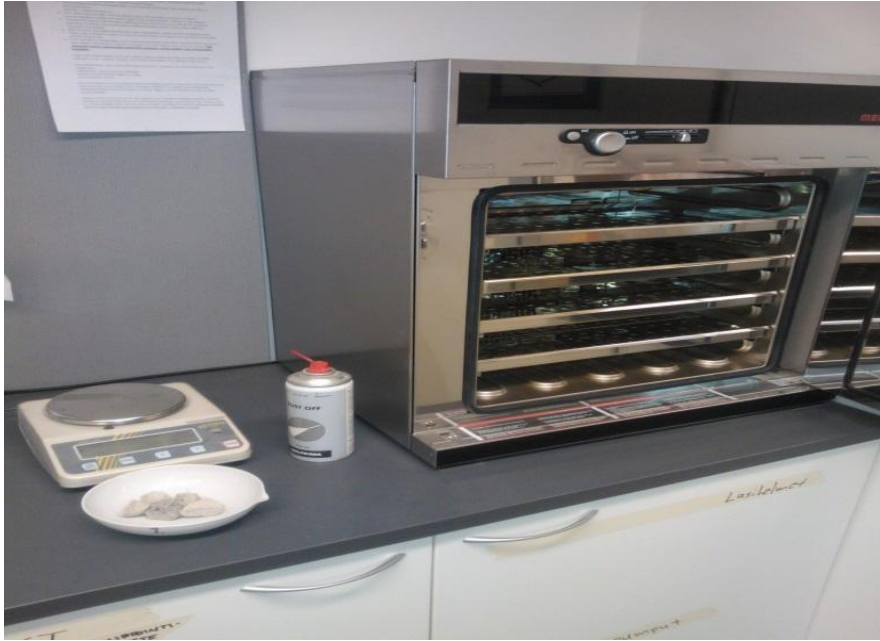
Kuva 8. Absoluuttisen kosteuden tutkimiseen tarvittavat laboratoriovälineet ovat lämpökaappi, laboratoriovaaka ja keraaminen astia betoninäytteelle (Valokuva Petri Virolainen 2013.)
