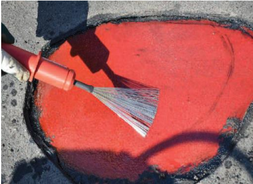
Kuva 11. Kalibrointikohdassa käytetään kapeaa harjamaista kipinäanturia (Iho 2012, 21.)
