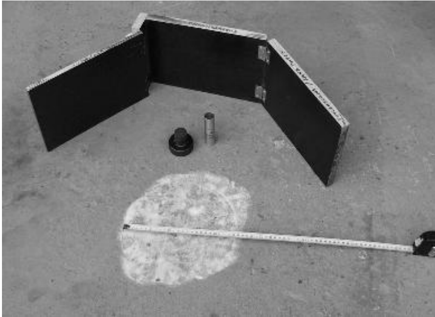
Kuva 7. Eristysalustan makrokarkeuden mittaukseen käytettävät mittausvälineet ovat metrimitta, lasihelmet, metallinen lieriöastia, kovakuminen kiekko kahvalla ja tuulensuojus (SILKO 1.801 2011, 26.)
