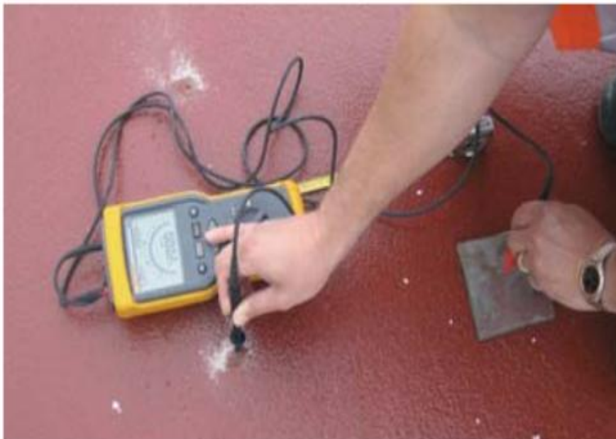
Kuva 10. Tiivistysepoxsin eristysvastuksen mittaus matalajännitemenetelmällä (Siltojen korjaus SILKO 1.801 2011, 26.)
