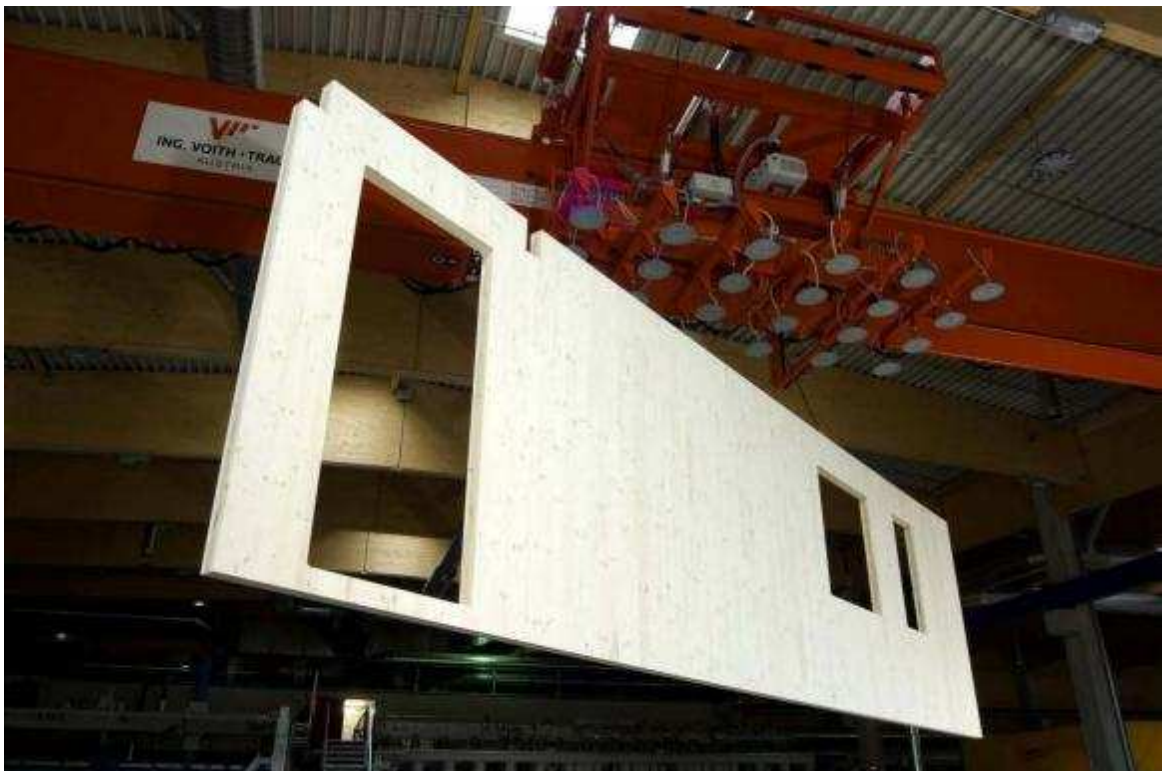
Kuva 5. Tyypillinen CLT -seinäelementti esivalmistetuilla ovi- ja ikkuna-aukoilla. [9.]
