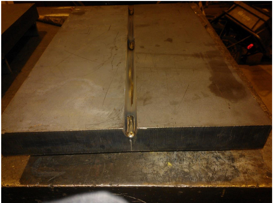
Kuva 17. Silloitettu u-railon koelevy
