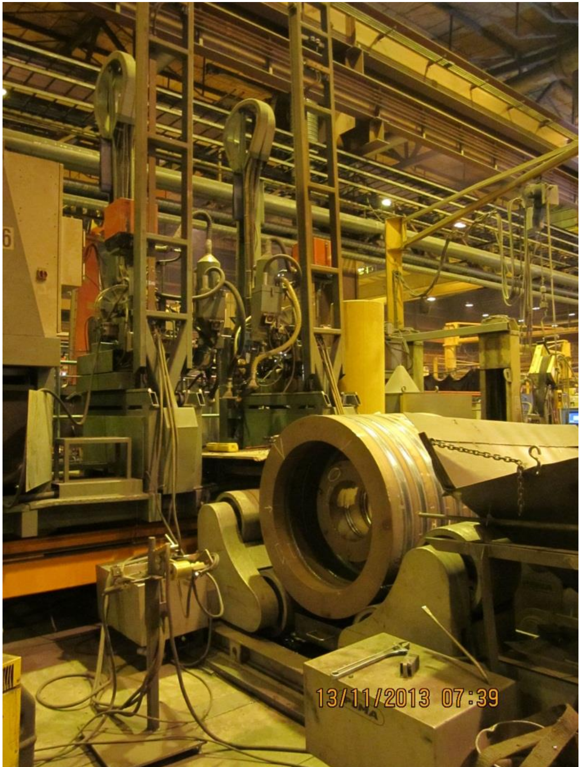
Kuva 11. Roottorin ulkokehän hitsauksen laitteisto
