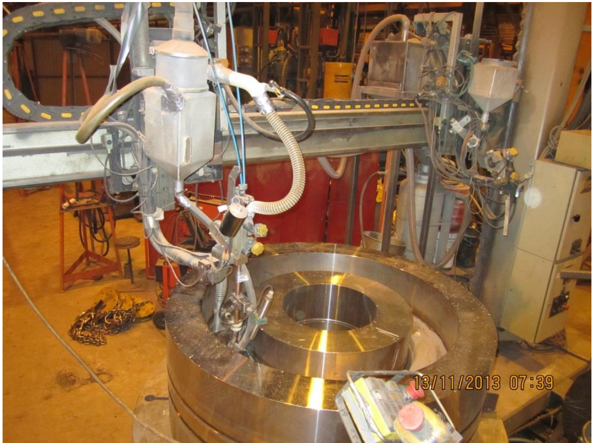
Kuva 10. Roottorin hitsaus Esabin tornilla
