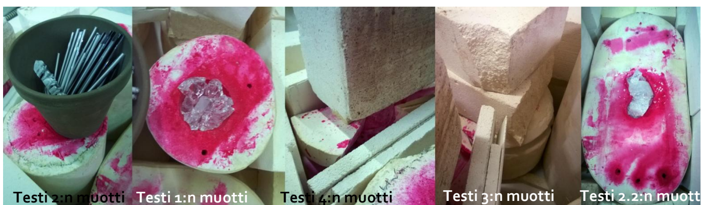
Kuva 19 Lasilla täytetyt muotit uunissa
