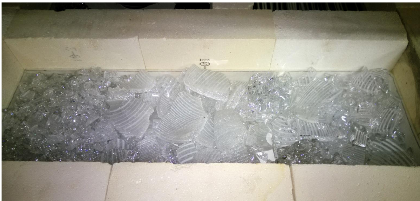
Kuva 8 Ensimmäinen sulatus. Erikokoista lasimurskaa. Kaoliinivillalevyt reunoissa.
