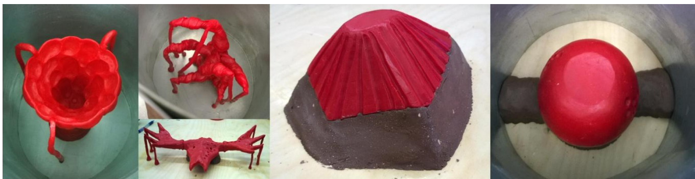
Kuva 17 Mallineet lisäosineen ja ilma-aukkoineen valmiina valuun.
