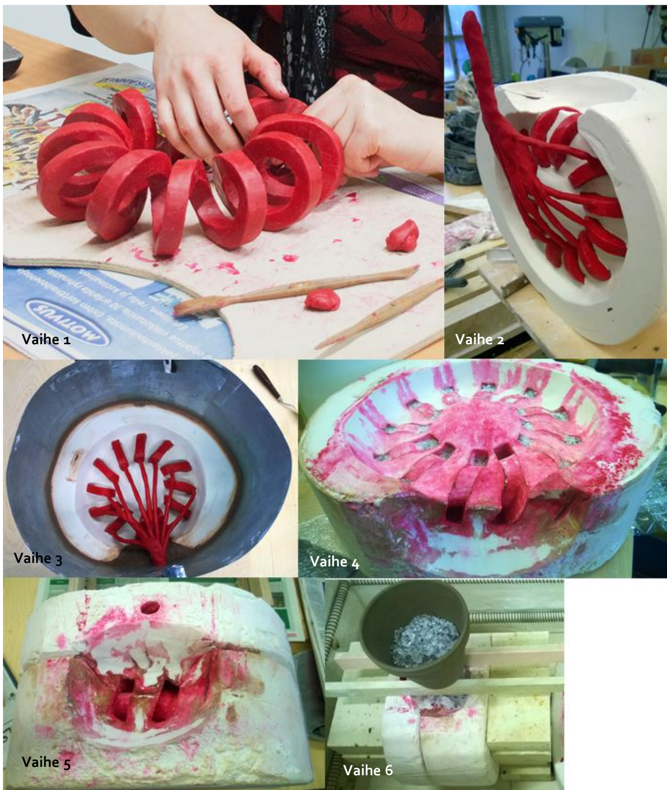
Kuva 33 Univaluprosessi. Kaksiosainen muotti.
