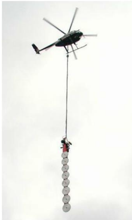
Kuva 14. Johtokadun raivaukseen käytettävä helikopteri ja linjasaha (Uusi-Rasi 2013, 43).
