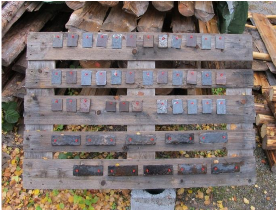
Kuva 3. Korroosiosuoja-aineiden testausasema Seurasaaressa, 18.10.2013.
