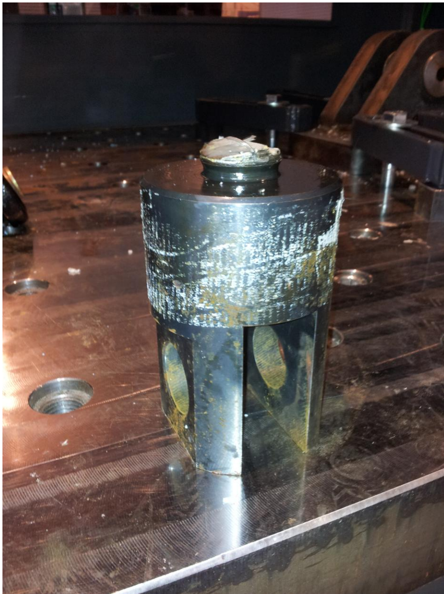
Kuvio 30. Testissä 6 murtunut kiinnike
