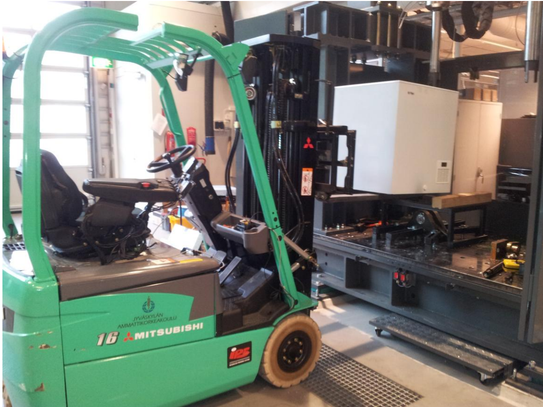
Kuvio 14. Laboratoriopakastimen asettelu kuormituskehälle
