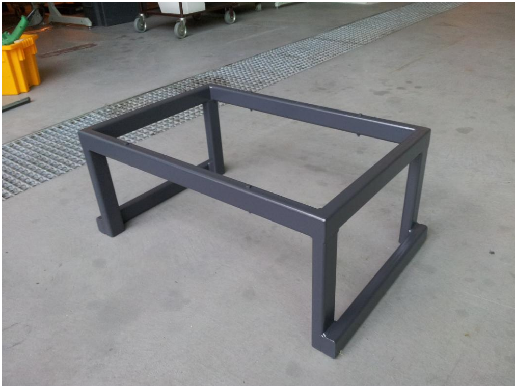
Kuvio 13. Teräsrakenteinen korotusteline
