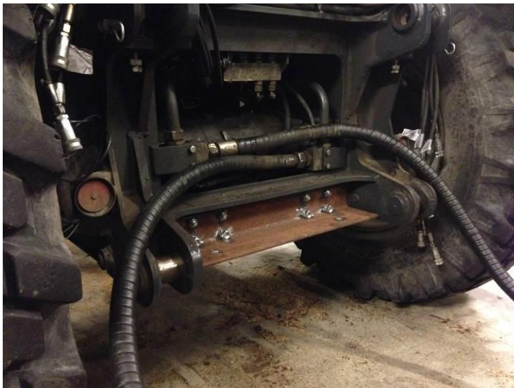
Kuvio 44. 17.12.2013 asennettiin pohjajanssarin kiinnitysrauta (Itäkylä 2013).
