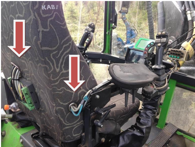
Kuvio 28 Hyttimoduuli ja siltä lähtevät johdotukset (Itäkylä 2014).
