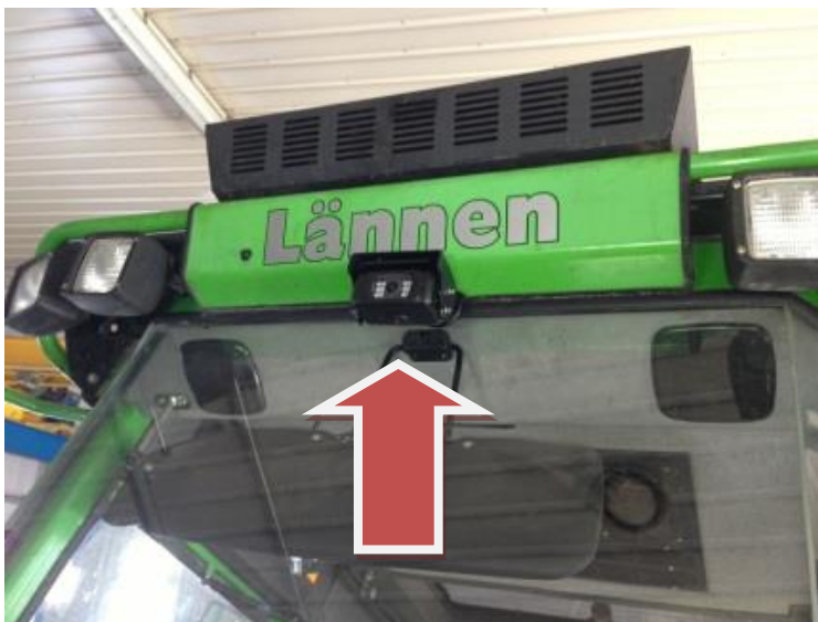
Kuvio 18. 18.1.2013 asennettiin peruutuskamera (Itäkylä 2013).
