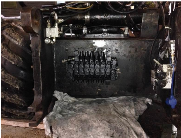
Kuvio 33. 1.11.2013 asennettiin uusi venttiilipöytä (Itäkylä 2013).
