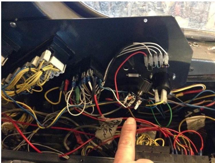
Kuvio 48. 3.1.2013 asennettiin manuaalisesti säädettävä painatuspotentiometri (Itäkylä 2014).
