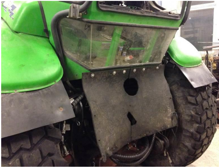
Kuvio 45. Venttiilipöydän suojapeitteen asennus 17.12.2013 (Itäkylä 2013).
