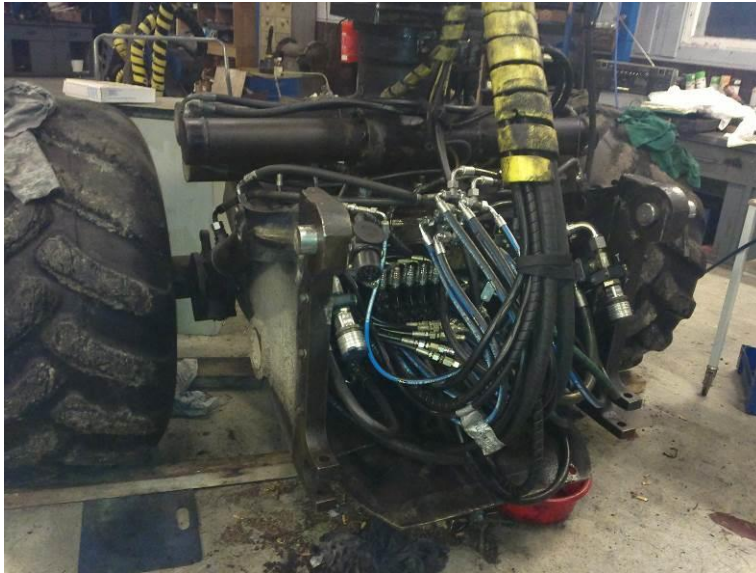
Kuvio 41. 12.12.2013 hydraulikkajärjestelmän letkutus oli valmiina (Itäkylä 2013).
