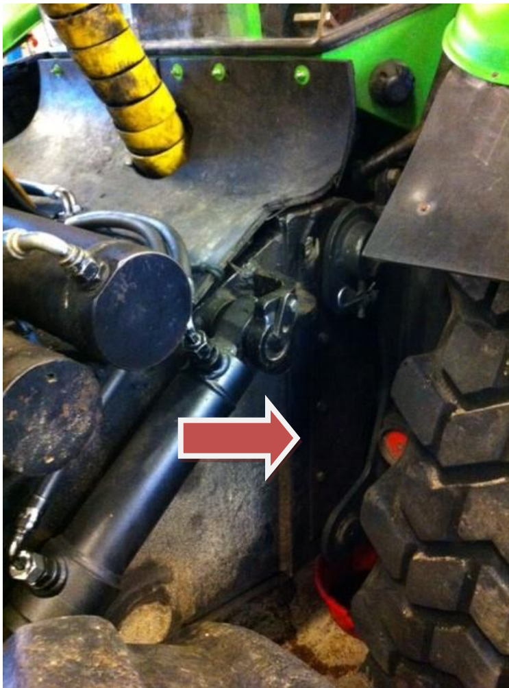
Kuvio 46. 18.12.2013 kiinnitettiin puomisto, pohjapanssari sekä sivupanssarit puomiston molemmille puolille (Itäkylä 2013).
