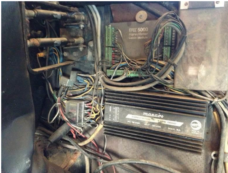
Kuvio 20. Mittalaitteisto kiinnitettyä Lännen C200 -koneessa (Itäkylä 2013).
