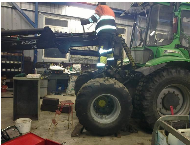
Kuvio 42. 13.12.2013 suoritettiin motopuomiston ensimmäinen kiinnitys sekä mahdollisten vuotojen kartoitus (Itäkylä 2013).
