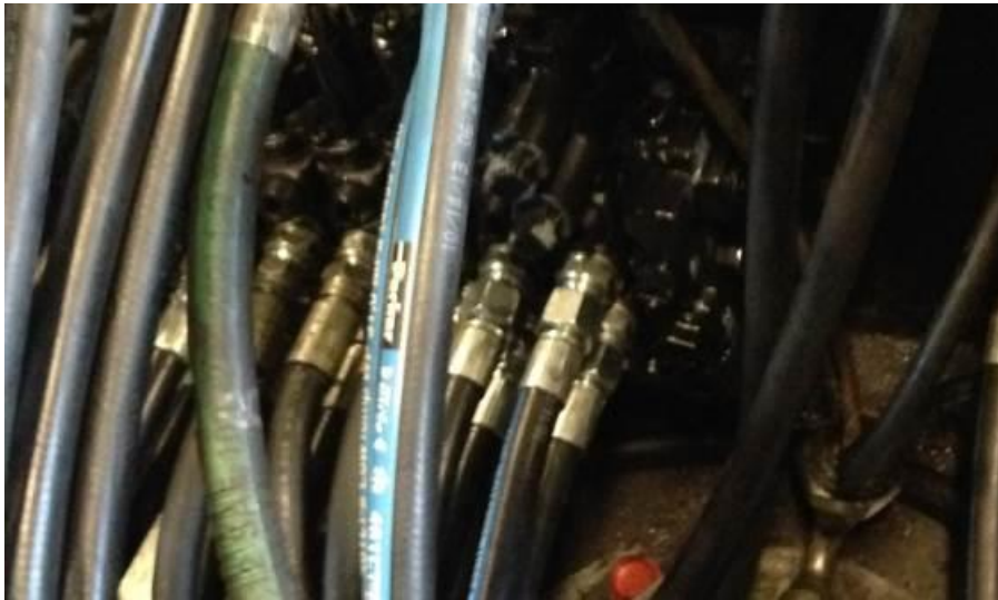
Kuvio 35. 15.11.2013 Motopuomiston hydraulikkaletkutukset kiinnitettiin uuteen venttiilipöytään (Itäkylä 2013).
