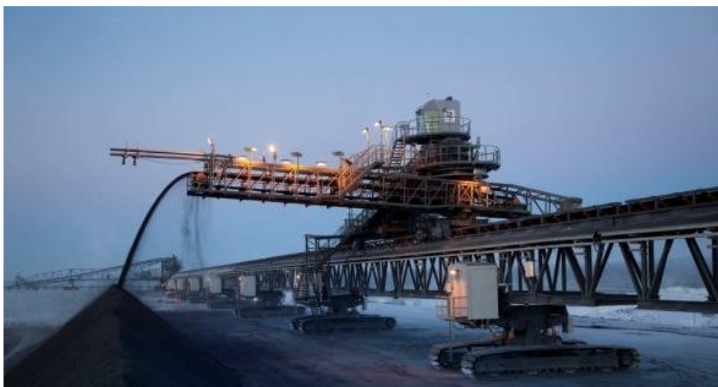
Kuva 6 Liikkuva tela-alustainen läjituskuljetinjärjestelmä (Paakkola Conveyors Oy:n www-sivut 2014, hakupäivä 21.1.2014.)
