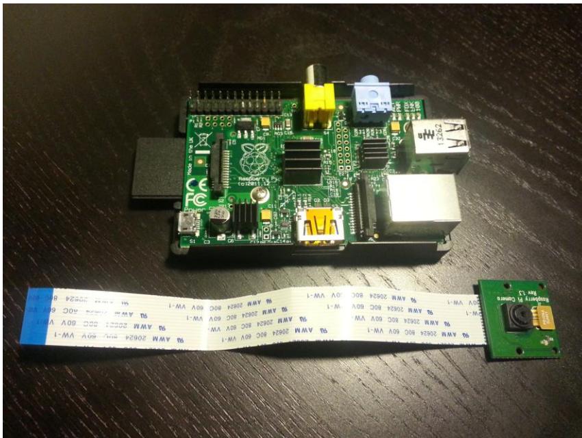
KUVA 4. Raspberry Pi:n kameramoduuli (alhaalla) ja Raspberry Pi (ylhällä).
