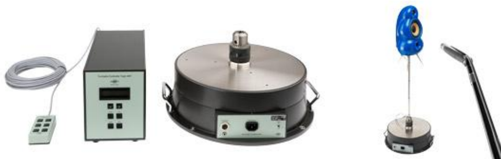
Kuva 19. Brüel & Kjær Turntable System Type 9640 -pyörityskone (10).
