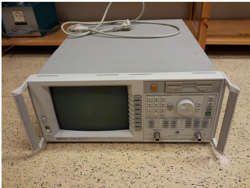
Kuva 18. Työssä käytetty Agilent 8714ET RF Network Analyzer.
