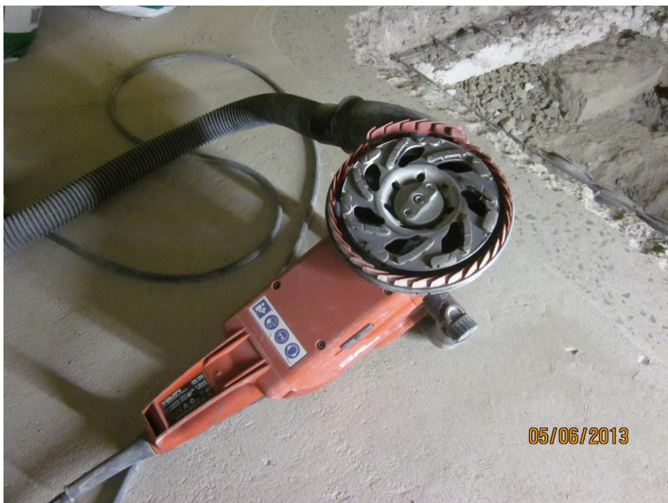
Kuva 5. Pienien pinta-alojen ja reuna-alueiden hiontaan soveltuva käsityökaluun kiinnitetty timanttikuppilaikka.
