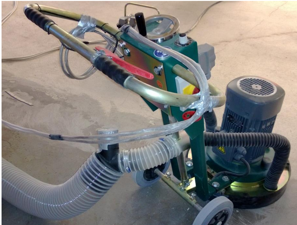
Kuva 4. Suurien lattiapinta-alojen hiontaan soveltuva timanttihiomakone.
