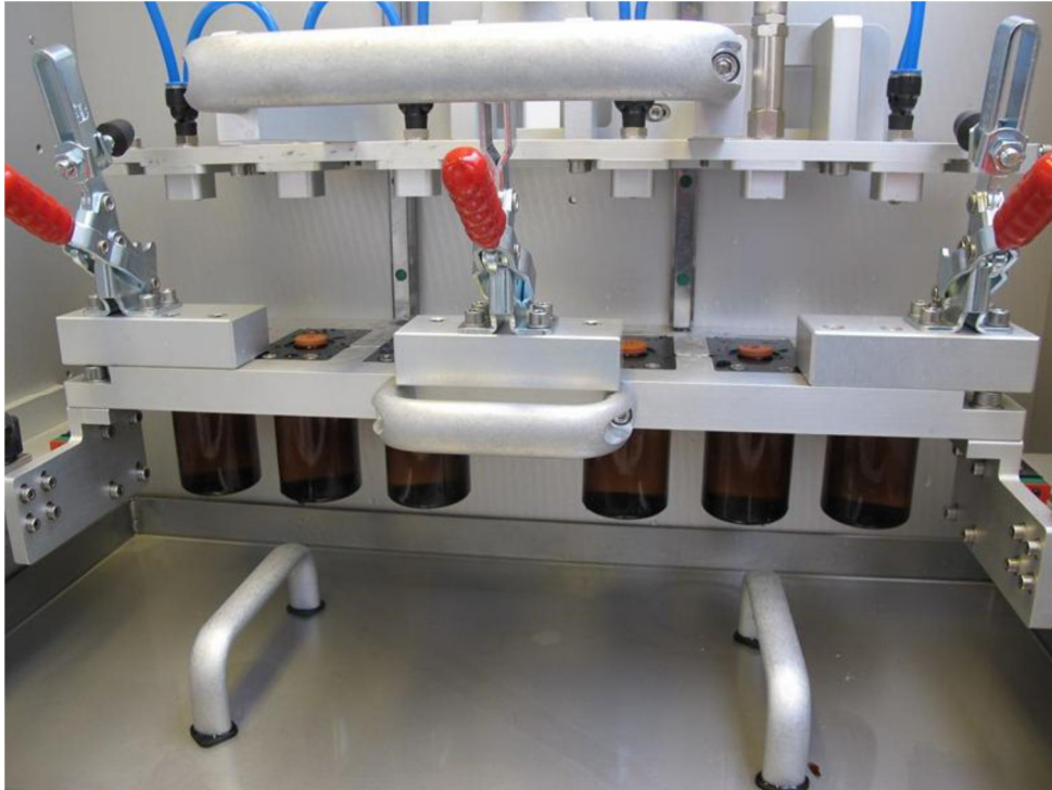
Kuva 10. Näytepullot uuden paineenkestolaitteen testipenkissä
