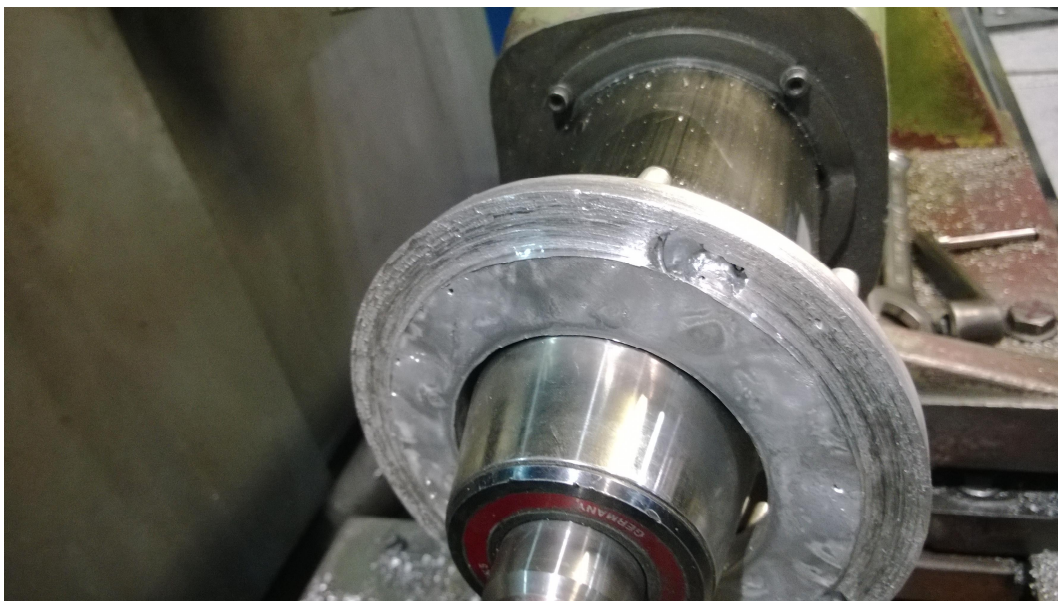
Kuva 13. Huokonen roottorin oikosulkurenkaassa.
