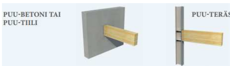
Kuva 9. Puu-betoni- ja puu-tiilikiinnikkeliitos sekä puu-teräskiinnikkeliitos [7, s. 12].
