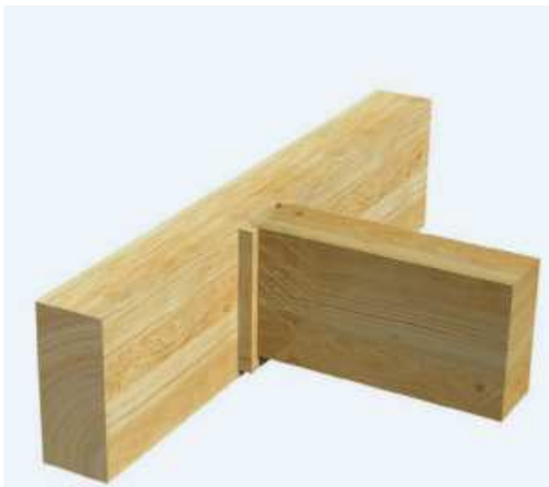
Kuva 10. Kiinnikkeen suojaaminen puulla [7, s. 13].
