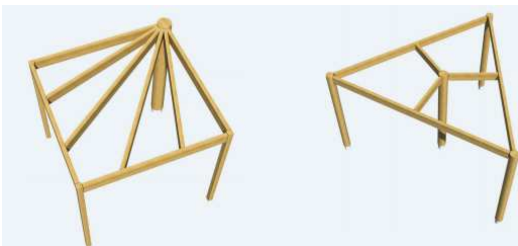
Kuva 6. Tähtimäiset rakenteet [7, s. 9].
