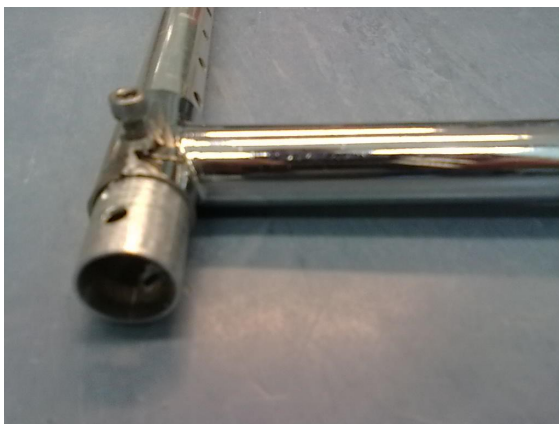
Kuvio 9. Poikkiputken kiinnitysmekanismi.
