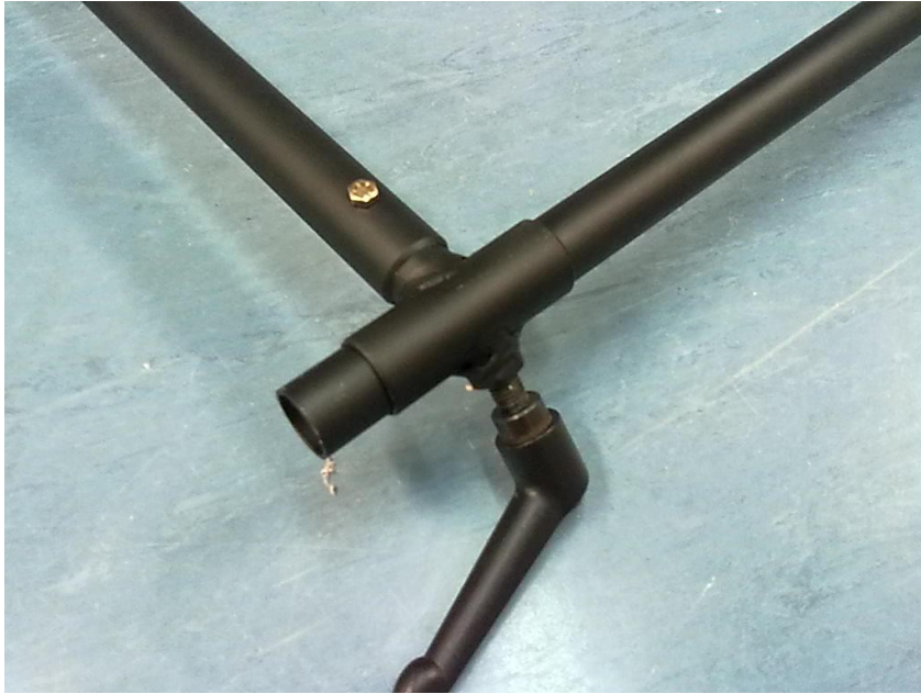
Kuvio 15. Poikkiputken kiinnitysmekanismi ja säätö vahvemmillä käsiruuveilla.
