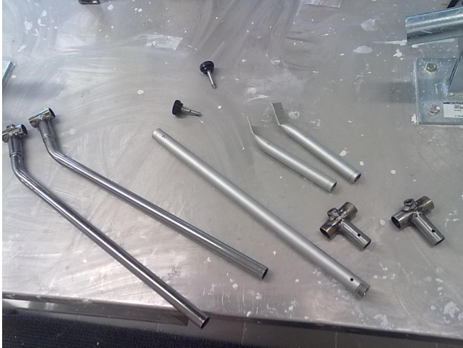
Kuvio 11. Tuen kehon muodostavat osat, sekä pienemmät käsiruuvit ennen kasausta.
