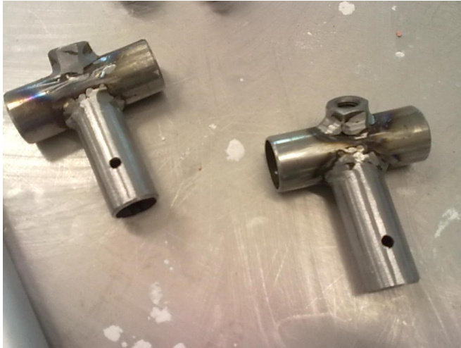
Kuvio 10. T-osat hitsattuina ja hiottuina, sekä niihin hitsattu mutterit.
