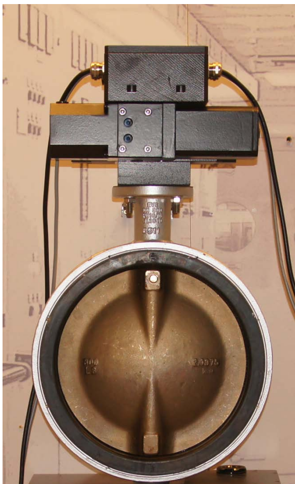
KUVA 1. Minipowerpack venttiin päällä (Valokuva Eero Ukkonen.)
