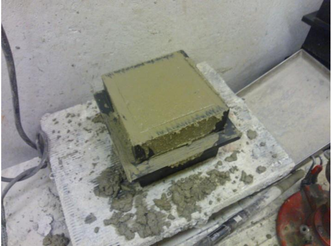
Kuva 5. Valmis muottiin valettu betoni.
