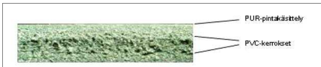
Kuvio 12: Homogeenisen PVC-lattianpäällysteen poikkileikkaus (Lämsä 2008, 12).
