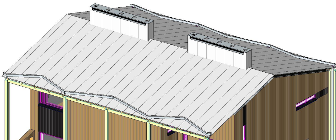
KUVA 23. Vesikatto, johon on mallinnettu yksityiskohdaksi pystykourut ja hormien piipunhatut.
