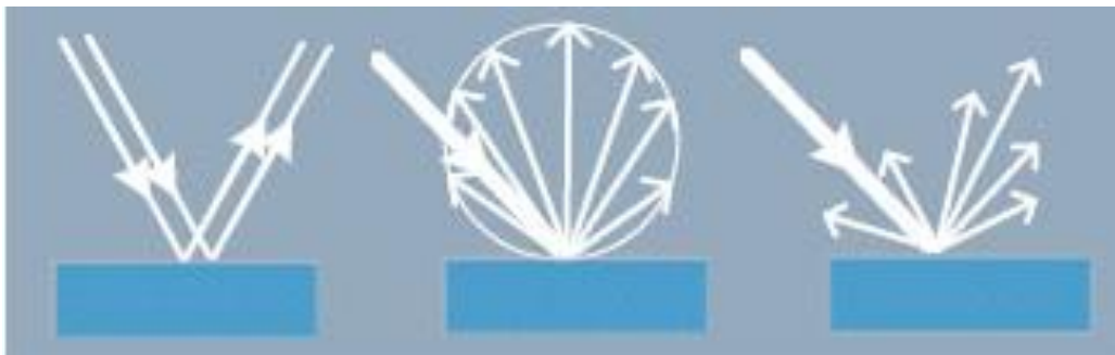
KUVA 12: Suuntaheijastuminen, hajaheijastuminen ja sekaheijastuminen. (8)
