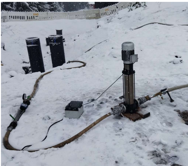
Kuva 13. Meneillään oleva painekoe (Antti Löyttynen 2022)
