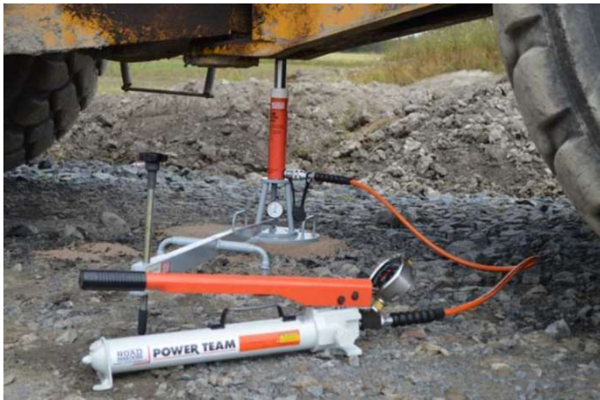
Kuva 21. Levykuormituskoelaitteisto (Roadmasters Oy).
