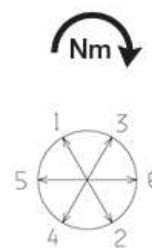
Kuva 11. Esimerkki AVK liittimien pulttien kiristyksestä. (AVK Supa Plus asennusohje, 2).
