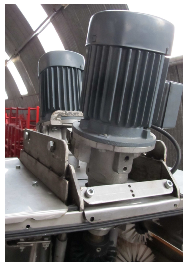
Figur 10. Visar hur sidoborstenheterna är ledade
