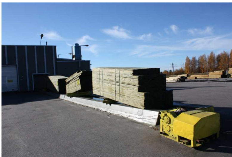
Figur 9. Överflödigt impregneringsmedel rinner av.
