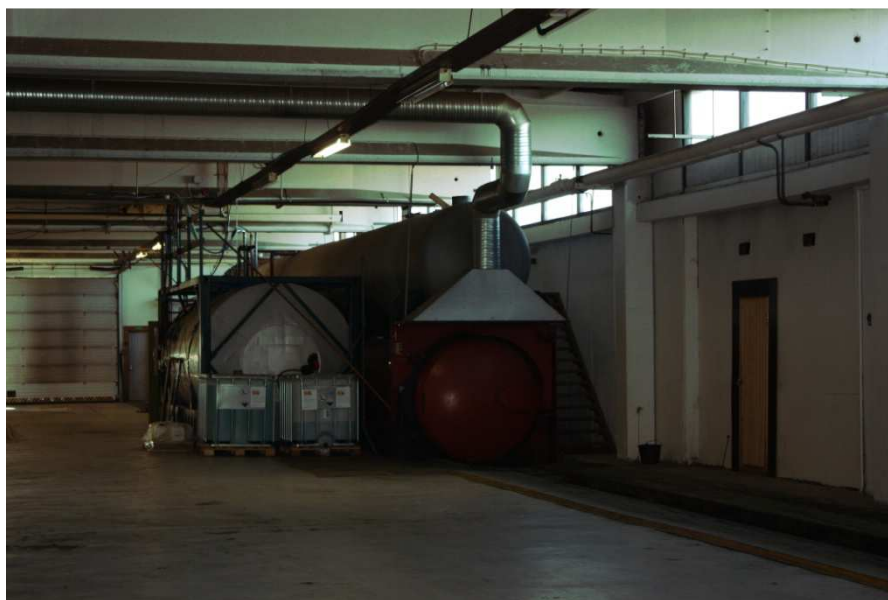
Figur 7. Autoklav för tryckimpregnering.
