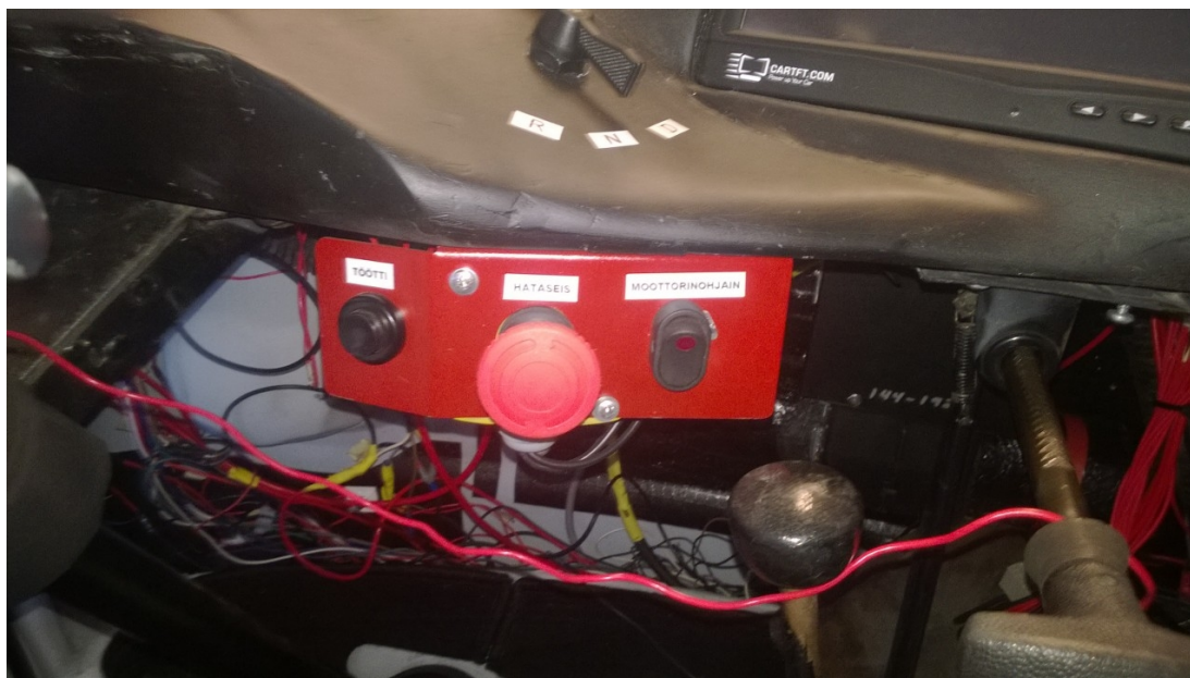
Kuva 13. Hätä-seis-painike S0.2 kojelaudassa (Taberman 2014)
