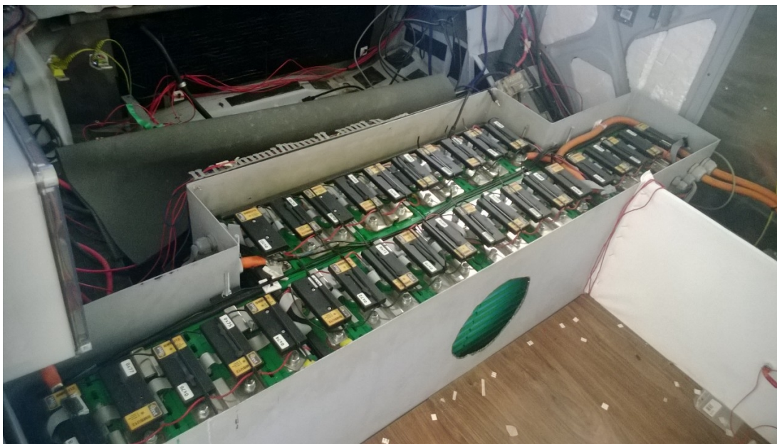
Kuva 5. Pääakuston ja BMS-järjestelmän toinen puolikas (Taberman 2014)
