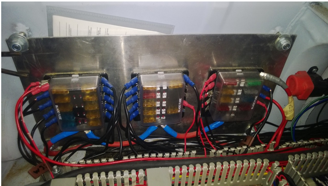
Kuva 12. F1-F30 autosulakkeet (Taberman 2014)
