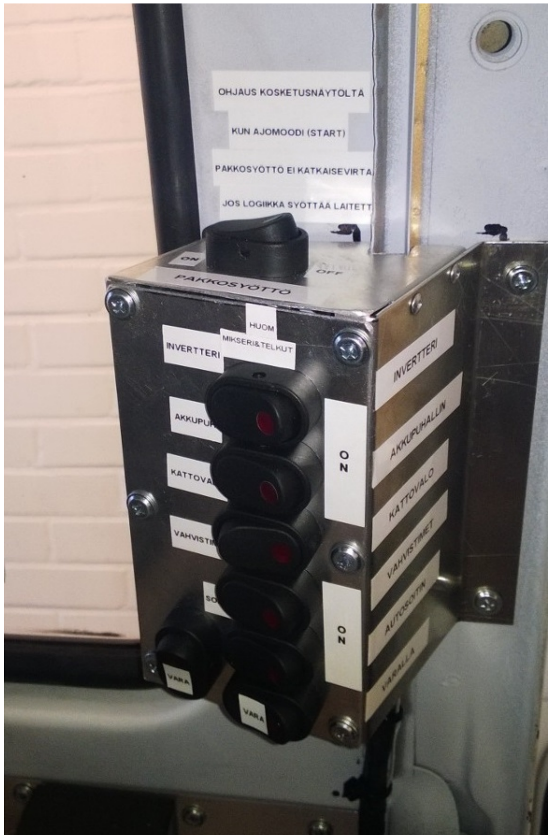
Kuva 20. Takatilan kytkimet S50-S55 ja S60 (Taberman 2014)
