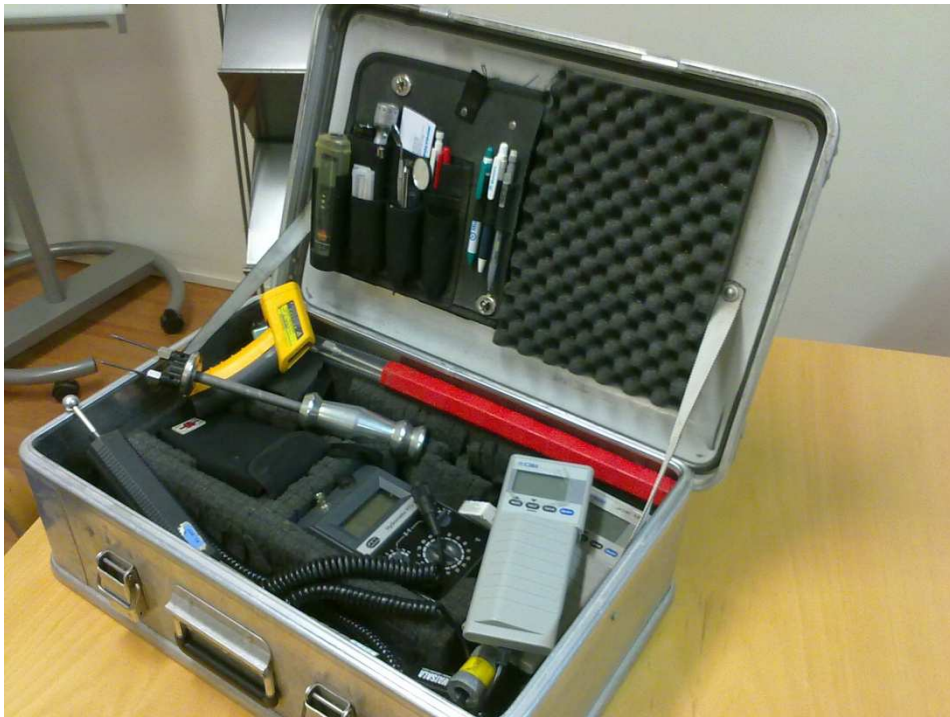
Kuva 1. Kosteuskartoittajan henkilökohtainen mittaussalkku mittalaitteineen ja pientyökaluineen.
