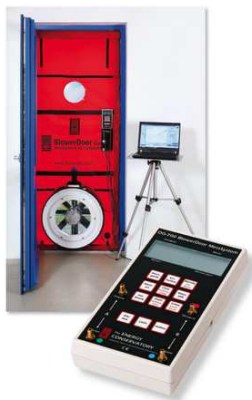
Kuva 4. Rakennuksen ilmatiiveyden mittalaitteisto. (Teknocalor Oy, 2014.)
