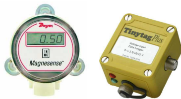
Kuva 3. Dwyer Magnesense + Gemini TGPR-0704 paine-erologgerijärjestelmä. (Amestec Oy, 2014.)
