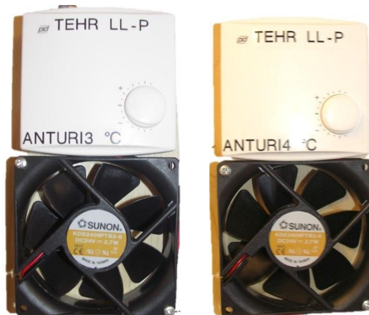
KUVA 13. Pro dual TEHR LL-P-lämpötila-anturit ja tuuletimet
