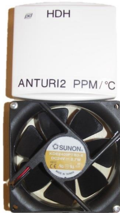
KUVA 12. Pro dual HDH -hiilidioksidi/lämpötila-anturi ja tuuletin
