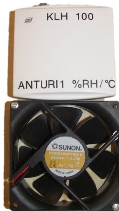
KUVA 11. Produal KLH 100 kosteus/lämpötila-anturi ja tuuletin
