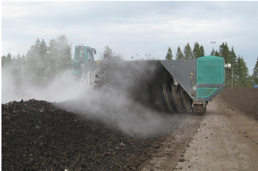
Kuva 6. Aumankäntölaite toiminnassa. Teloilla kulkevassa aumankäntölaiteessa on keskellä suuri ruuvi, joka pyöriessään kääntää kompostimassaa. Kompostiauman käännön yhteydessä kompostista vapautuu runsaasti lämpöä. Kuvassa aumankäntölaitteen juuri kääntämää, höyryävää kompostia. (Kuva: Joonas Enqvist)
