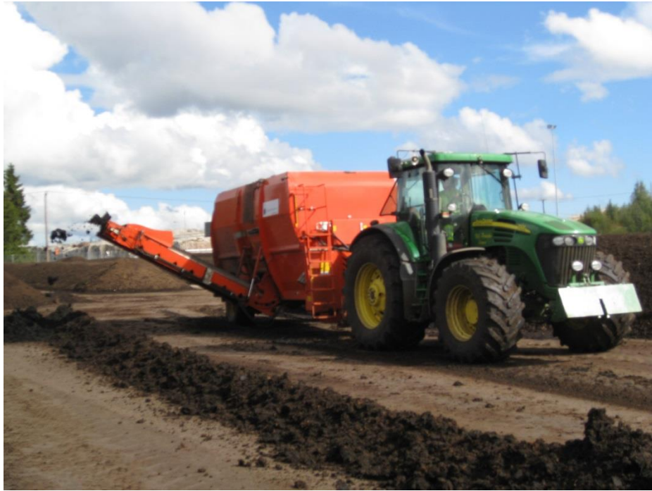
Kuva 5. SEKO-vaunu toiminnassa. Vaunussa on kaksi vaakaruuvia, jotka sekoittavat kompostimassaa. Vaunu puretaan suoraan kompostiaumaksi kuljettimen avulla. Vaunut saavat käyttövoimansa vetotraktoreista. (Kuva: Joonas Enqvist)
