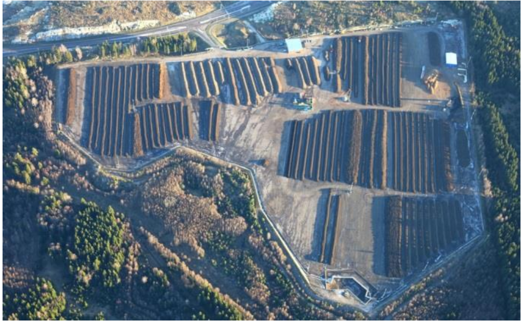
Kuva 4. Ilmakuva Metsäpirtin kompostointikentästä. Säännöllisesti otettuja ilmakuvia käytetään karttoina. Ne helpottavat töiden suunnittelua ja kompostiaumojen seuranta. (Kuva: Markku Korja)
