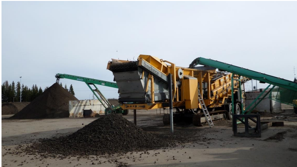
Kuva 7. Seula-asema toiminnassa. Kuvassa näkyy tähtiseula-akseli, joka pyöriessään seuloa kompostia. Etualalla näkyy karkeinta seulaylitettä. Takana vasemmalla näkyy valmista kompostimultaa. (Kuva: Joonas Enqvist)
