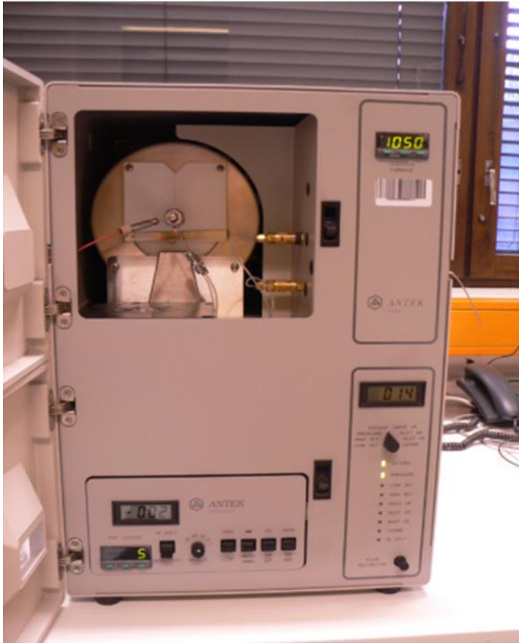
Kuvio 5. Uunin lämpötila pysyi vakiona 1050 °C:ssa.
