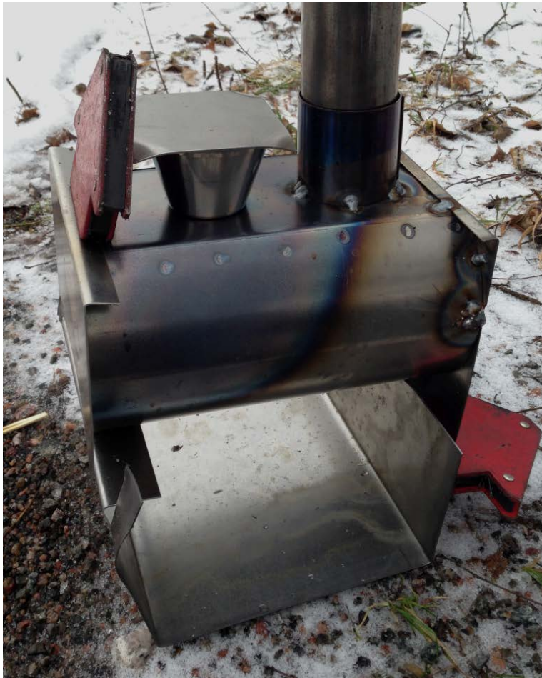
Kuva 12. Kamiinan pinnan värjäytyminen pinnan lämmetessä
