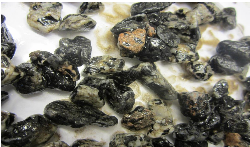
Kuva 23. 72 tunnin jälkeen bitumin peittoaste arvioidaan. Kuvassa on näyte D, joka arvioimishetkellä näytti tältä.
