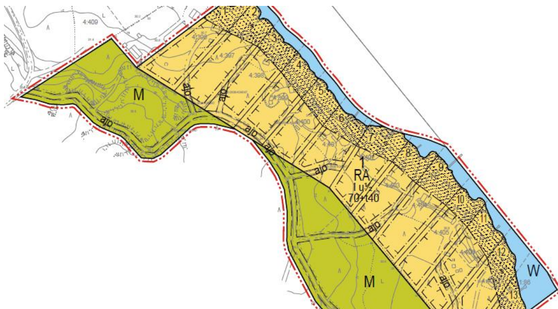
Kuva 5. Ote Manulan ranta-asemakaavasta (2014), Raumalta. Kaavassa on osoitettu tontit, näille johtavat tieyhteydet, rakennusoikeus, rakennusala ja liito-oravaa varten puustoisena säilytettävä alue pisterasterilla rannassa.
