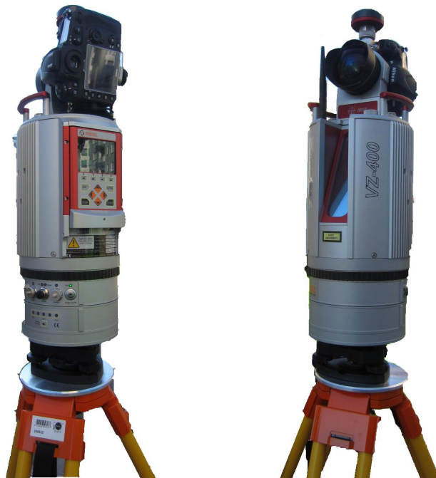
Kuva 4. Riegl VZ-400 -laserskanneri (kuvat Teemu Rekonen).
