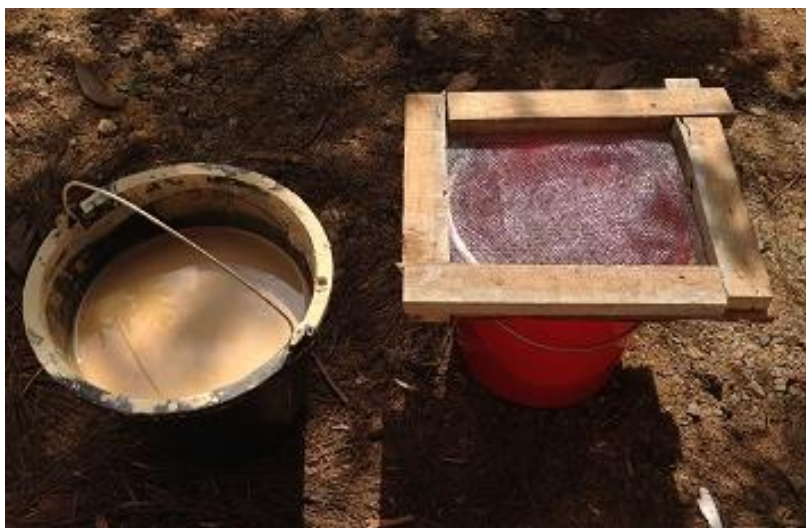
Kuva 23. Saven erottelua siivilän läpi. Karkeat ainekset jäävät siivilään, hienojakoinen savi kulkeutuu siivilän läpi ämpäriin. Hienojakoista savea on helpompi työstää keramiikassa. Karkeammat massat ovat hyviä rakentamisessa. ©Hannah Weisenberg, 2013
