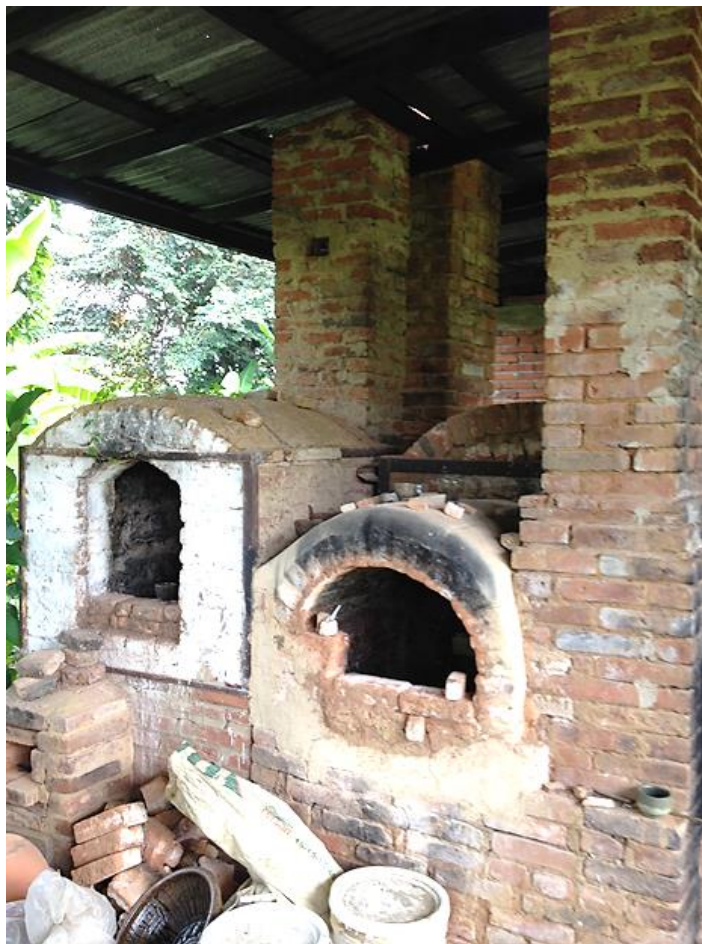
Kuva 13. Jarabacoassa asuva suomalaissyntyisen Lauri Ylitalon keramiikkaharrastajan kotipihassa olevat puupolttoiset keramiikkauunit. Ylitalolla oli yhteensä kahdeksan erimallista ja kokoista puu-uunia. Kuvassa oikeanpuoleinen Laurin pienin koepolttoihin tarkoitettu uuni toimi rakennusmallina Rio Limpion uunille. ©Hannah Weisenberg, 2013
